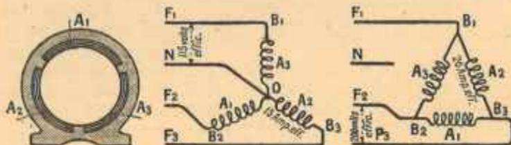
FIG. 26, 27 et 28. — Montages des moteurs sur le triphasé.
