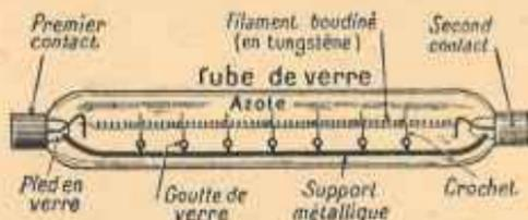
FIG. 87. — Lampe tubulaire à filament rectiligne.
