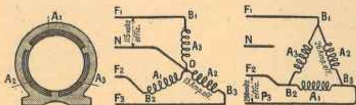
FIG. 26, 27 et 28. — Montages des moteurs sur le triphasé.
