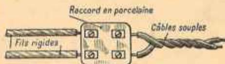
FIG. 57. — Jonction des câbles souples aux fils rigides par un serre-fil, dit « domino ».
