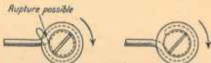
FIG. 48 et 49. — Deux mauvais montages de fusibles.
