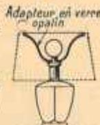
FIG. 98. Adaptateur en verre opalin pour éclairage mixte.
