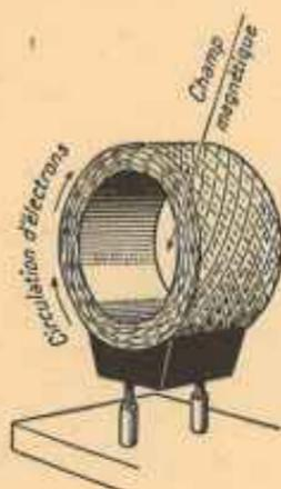
FIG. 5. — Champ magnétique produit par une self.
