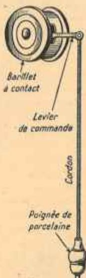
FIG. 42. — Pour éviter l'électrocution dans les salles de bains.
